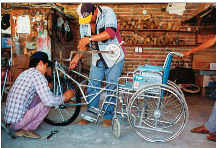
Marcelo era excepcionalmente creativo. Aquí está desarrollando y construyendo un triciclo impulsado con las manos removible, sujeto a una silla de ruedas para atravesar carreteras escabrosas más fácil y rápido.
