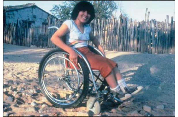
Muchos niños viven en la zona rural o los barrios con calles muy disperejas o arenosas, donde una silla de ruedas estándar se atasca. Por eso, en Duranguito hacen la silla de ruedas "Torbellino," que tiene las llantas anchas y con buena tracción.
