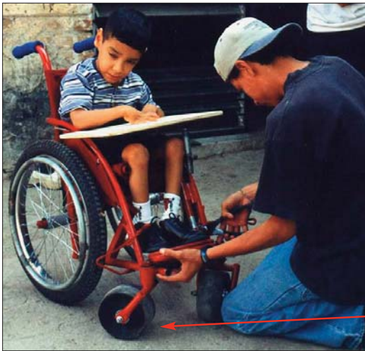
Últimamente, para las ruedas delanteras, están utilizando mucho la "llanta de Zimbabwe." Es hecho de hule vulcanizada: muy fuerte pero tan flexible como una llanta neumática—con la ventaja que no se poncha, ni con las espinas ni con piedras picudas.
