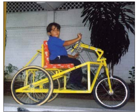
Para este niño con espina bífida, que tiene que ir lejos a la escuela sobre caminos desparejos, le hicieron un triciclo manual. Los triciclos son más rápidos y seguros que una silla de ruedas normal.
