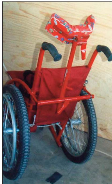
Esta silla tiene una cabecera totalmente ajustable, de altura, de ángulo, y de inclinación.
