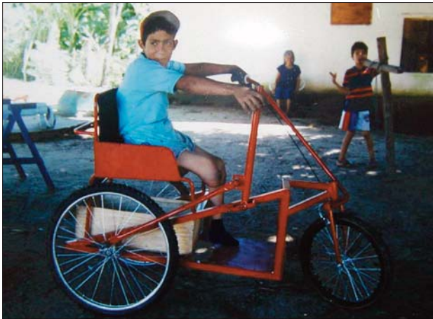
Otro modelo de triciclo se hace marchar bombeando una palanca con una mano, mientras controla la dirección con la otra mano. Este modelo es especialmente útil para una persona hemipléjica que tiene una mano más débil.
