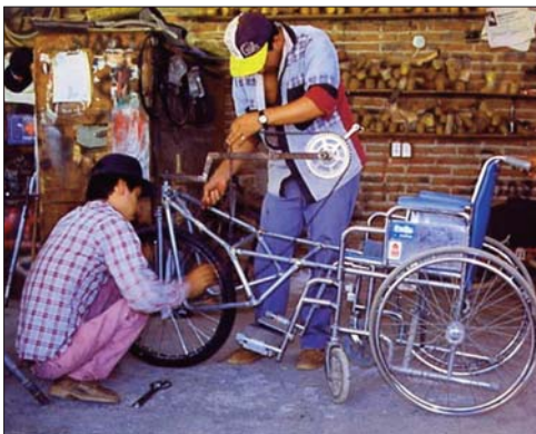
Por eso ellos han experimentado con un modelo de triciclo que tiene removible la rueda delantera grande—para poder quitársela fácilmente, y entrar a los edificios con la pura silla de ruedas de ruedas ordinario.
